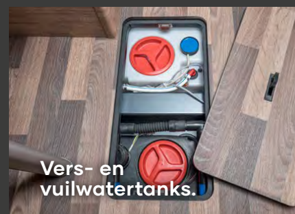
Centrale en goed bereikbare bedieningselementen voor de vers water/grijsstank, evenals voor het waterfilter, de vorstklep en de stroomaansluiting.
